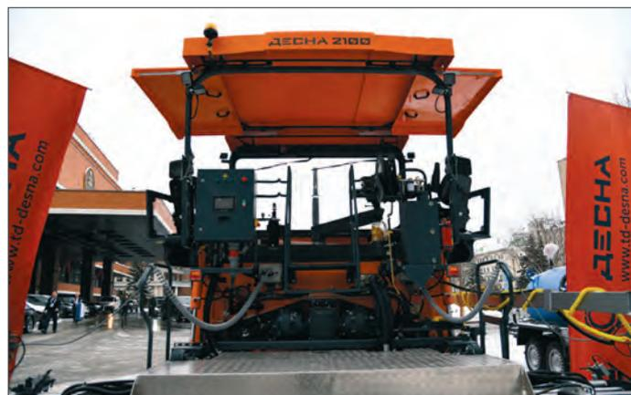
ша для защиты от непогоды оснащена гидравлическим подъемом и складыванием. Также устроено регулируемое поворотно-выдвижное место машиниста (благодаря выдвигаемым в стороны за корпус машины сиденьям оператор имеет оптимальный обзор рабочей зоны и бункера).
