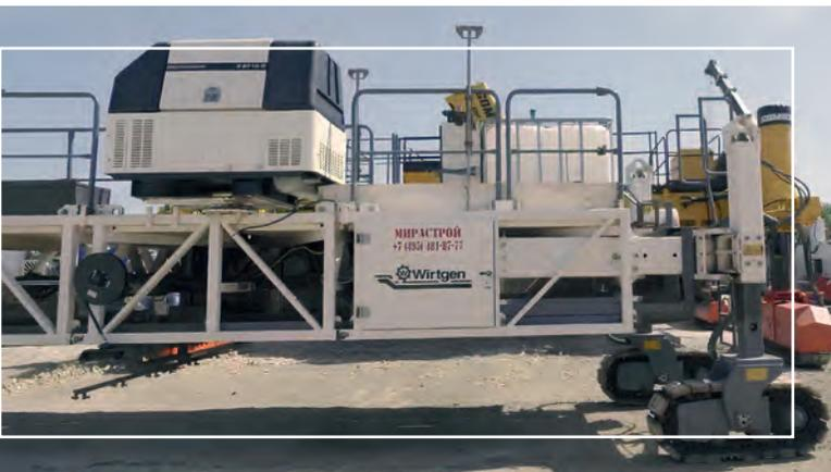
Текстурировщик WIRTGEN TCM 1800 — это самоходная техника с гусеничной ходовой частью. Предназначен для создания текстуры и нанесения защитного покрытия на поверхность уложенного бетонного покрытия. Управление техникой максимально упрощено. Работа щеток, гребенок и форсунок для нанесения ПОМ (плёнкообразующий материал) автоматизирована.
