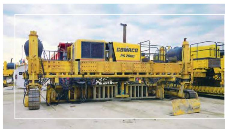
Распределитель незаменим при укладке покрытия с армированием, поскольку, если имеется армокаркас, самосвал не может на него наезжать, а значит должен выгружать бетонную смесь сбоку. Распределитель работает как перегружатель, позволяя бетоноукладчику двигаться без остановок, что, безусловно, значительно повышает качество покрытия: не образуются волны, сопровождающие остановки.
