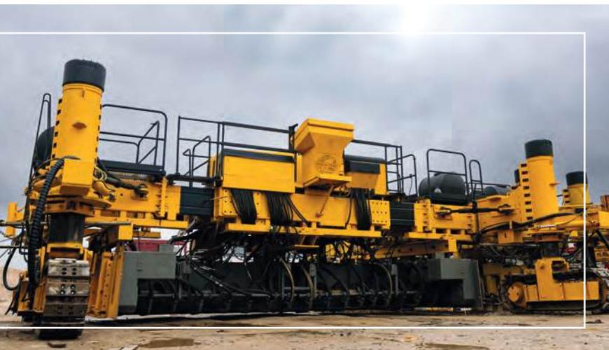
GOMACO GHP-2800 — это самый надежный и проверенный временем бетоноукладчик в мире среди своих собратьев. Укладка качественного дорожного покрытия обусловлена плавным возрастанием и снижением скорости движения в рабочем режиме.
