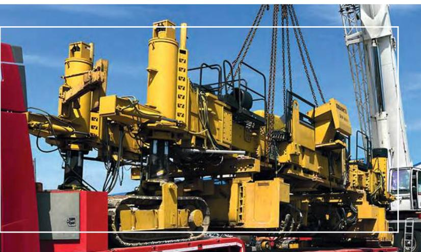
Распределитель GOMACO PS-2600 входит в бетоноукладочный комплект, идет в двадцати-тридцати метрах перед бетоноукладчиком для того чтобы распределить бетонную смесь. У машины имеется ленточный конвейер, на который самосвал выгружает бетон, подъезжая сбоку. По конвейеру смесь передается уже на полосу, после чего шнек, расположенный впереди машины, распределяет бетон.
