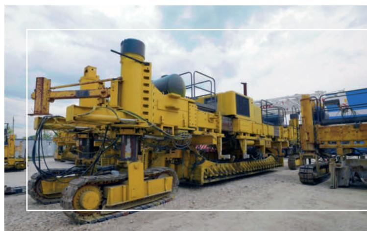
Распределитель незаменим при укладке покрытия с армированием, поскольку, если имеется армокаркас, самосвал не может на него наезжать, а значит должен выгружать бетонную смесь сбоку. Распределитель работает как перегружатель, позволяя бетоноукладчику двигаться без остановок, что, безусловно, значительно повышает качество покрытия: не образуются волны, сопровождающие остановки.
